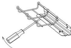
Se requieren 2 Clip Automático por cada acoplamiento de tramos rectos y/o derivación independientemente del ancho de la charola
